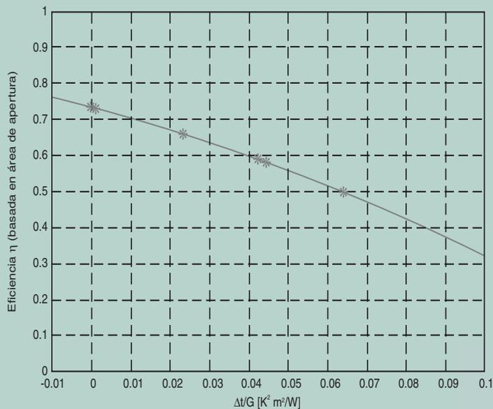
Curva de eficiencia con los puntos medidos en base a la área de apertura 0,574 m<sup>2</sup>
